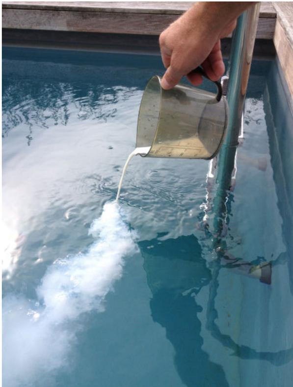
Anregung des Filters 4 Tage vor der Probeentnahme mit Apfelsaft und Milch.
